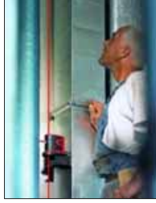
Referans noktasını hızlı biçimde zeminden çatıya taşır.
